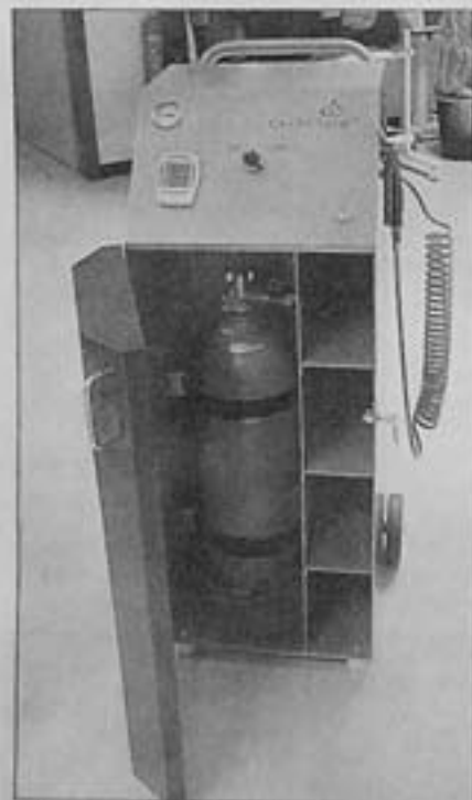
In dem Gerät befindet sich eine CO 2 -Flasche. „Carboflow“ ist flexibel einsetzbar.
